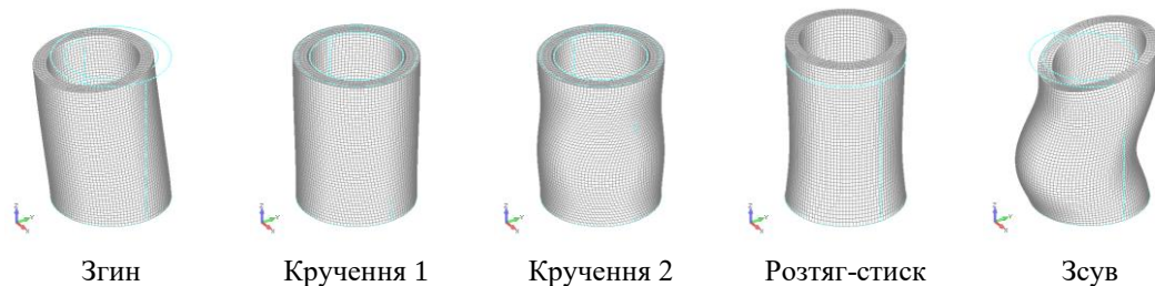
Рис. 7.79. Форми коливань оболонки d/R_c=1/4 (FC)
