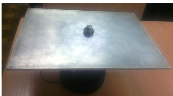
Рис. 6.5. Пластина закріплена на п'єзокерамічному вібраторі
